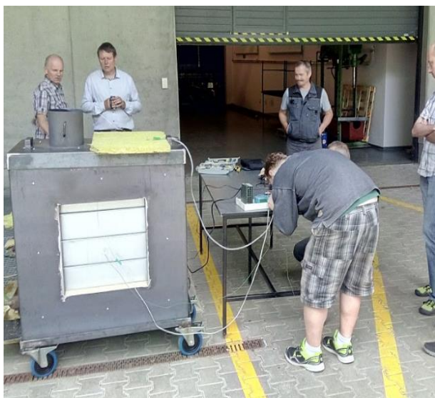
Obr. 1: Průběh testu – připravená komora s instalovanými termočlánky (vlevo), průhled do komory se zažehnutým hořákem (vpravo)
