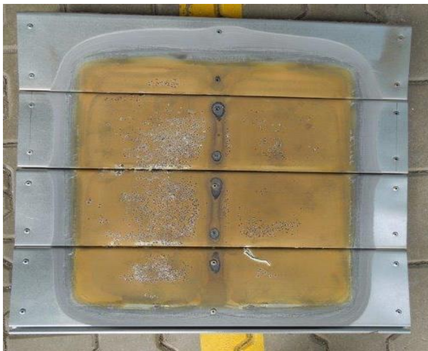
Obr. 2: Zmenšený model uzávěru po ukončení testu
