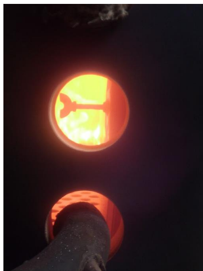
Obr. 1: Průběh testu – připravená komora s instalovanými termočlánky (vlevo), průhled do komory se zažehnutým hořákem (vpravo)
