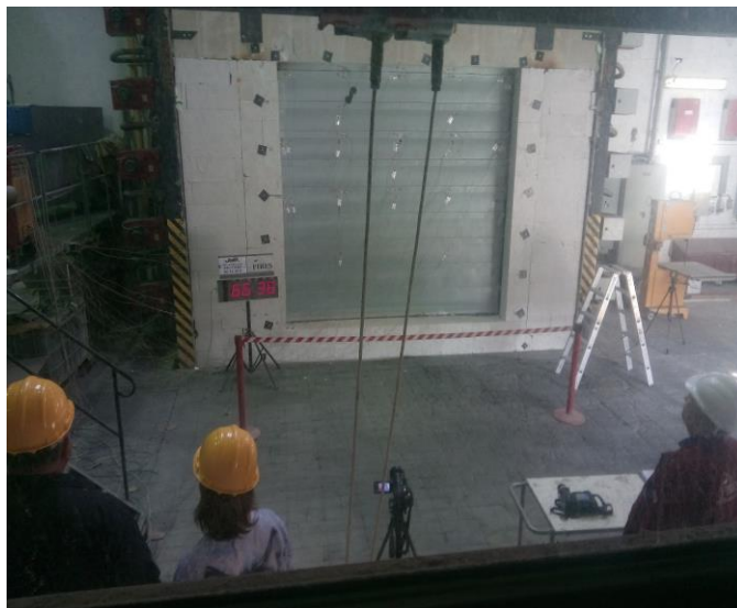
Obr. 1 – Lamelová rychloběžná protipožární vrata – vlevo pohled na instalovaná vrata v dílně, vpravo zkouška protipožární odolnosti v certifikované laboratoři firmy FIRES
